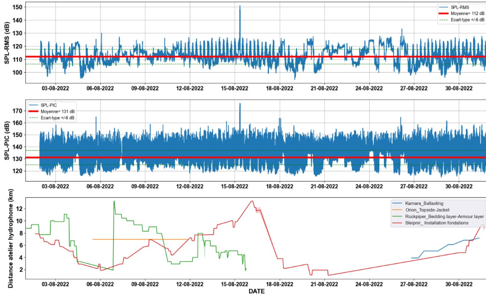
Figure 39 : niveaux SPL-RMS et SPL-PIC (zero-to-peak) (dB re 1 $\mu$ Pa) sur la période d'acquisition calculés dans la zone du parc au point d'enregistrement H2 à l'été 2022 au cours de trois ateliers de travaux. La distance des différents navires de construction par rapport au point d'enregistrement H2 est également représentée. Cette distance au point d'enregistrement varie avec les mouvements des navires par rapport aux opérations à mener.
