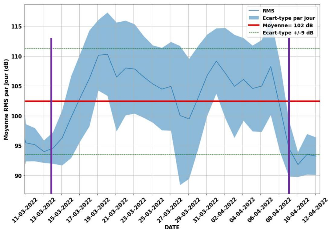
Figure 7 : niveaux SPL-RMS (dB re 1µPa) moyen par jour et sur la période d’acquisition calculés dans la zone du parc au point d’enregistrement H2 au printemps 2022 lors du forage des pieux de la sous-station électrique. La période de travaux suivie est représentée par les lignes en violet.
