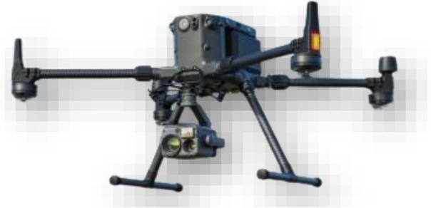
Figure 8 : Drone M300 et son capteur H20T DJI
