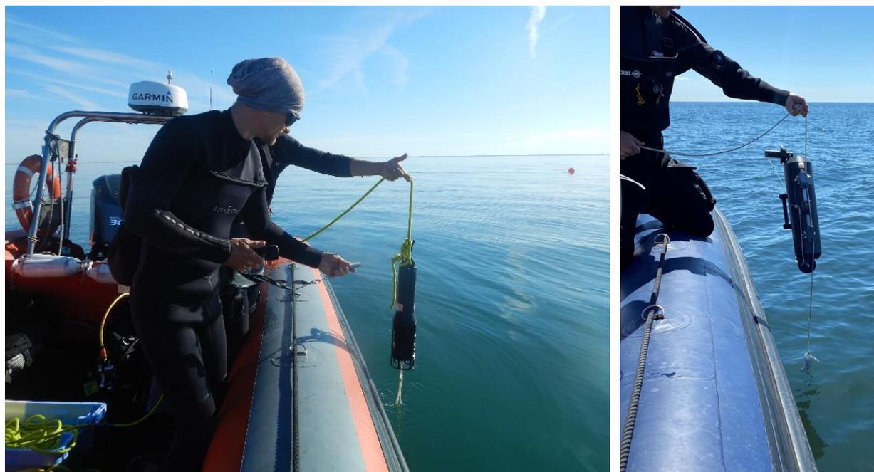
Figure 3. Gauche : mise à l'eau de la sonde multi-paramètres WiMo. Droite : prélèvements par bouteille NISKIN
