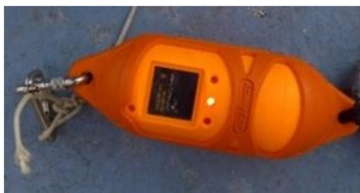
Figure 14. Sonde CTD utilisée pendant le survey
