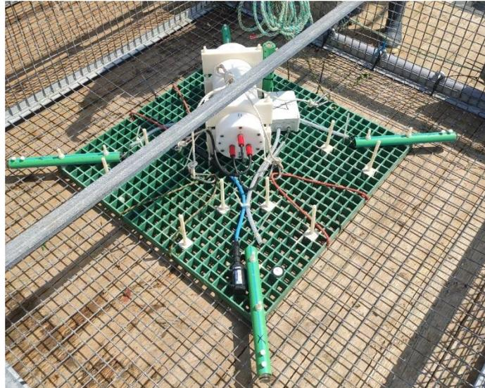
Figure 29. Un instrument STATEM configuré avec des dipôles électriques de 5 m.
