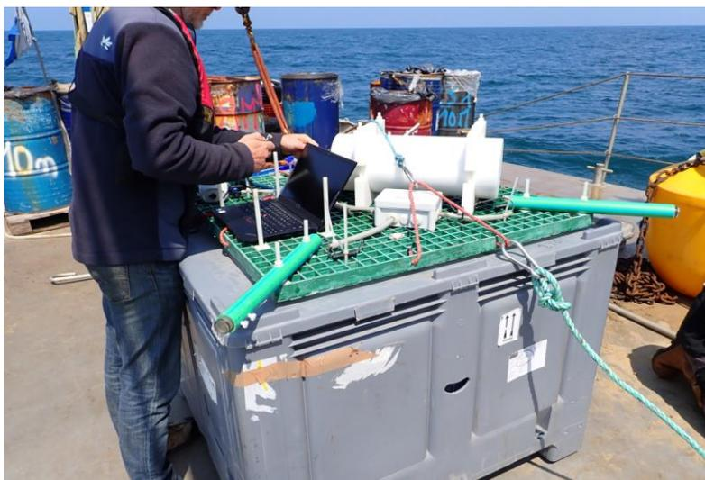
Figure 31. Déclenchement du début de l'acquisition d'une station STATEM par MAPPEM Geophysics.
