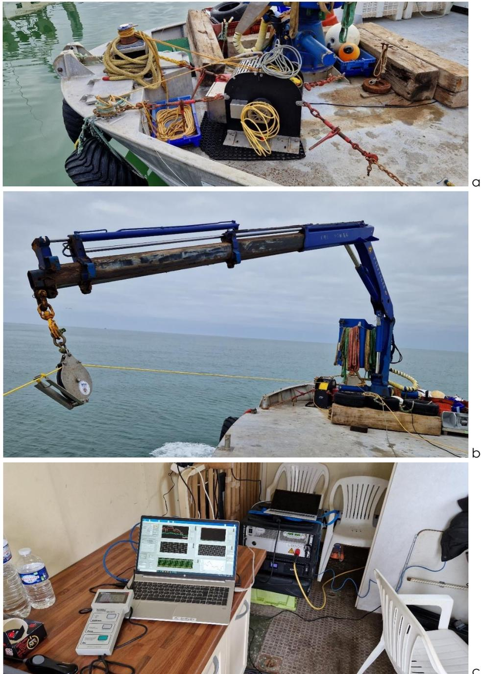
Figure 15. (a) Photographie du treuil. (b) Photographie du treuil et de la poulie avec le système à la mer. (c) Photographie du poste d'acquisition
