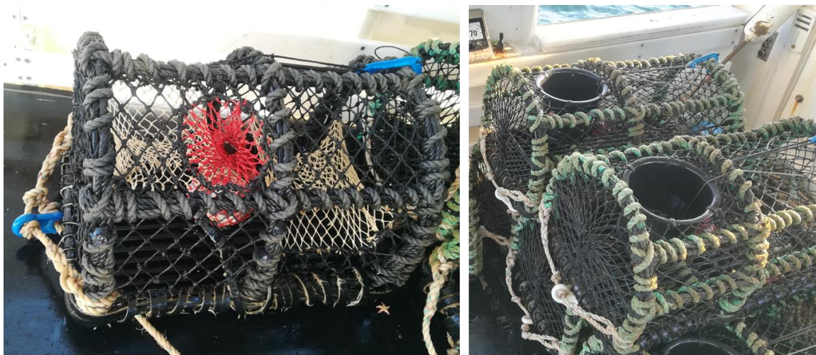
Figure 22: Deux types de casiers : à gauche casier avec deux entrées souples, à droite casier avec goulotte plastique.
