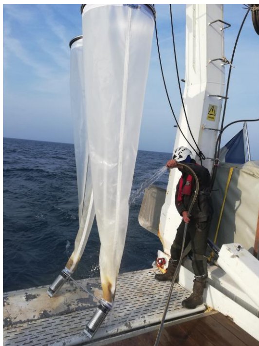
Figure 10: À gauche filet bongo et son dépresseur de 5 kg, à droite débitmètre à l'entrée du bongo
