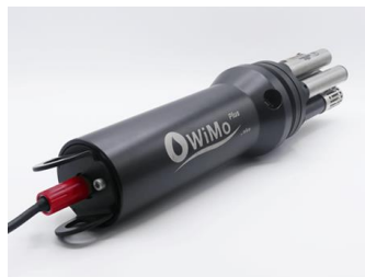
Figure 6 : Sonde multi-paramètres WiMo (NKE)
