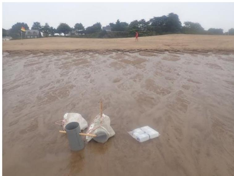
Figure 4: Carottier à main et tamis pour les peuplements benthiques de substrats meubles
