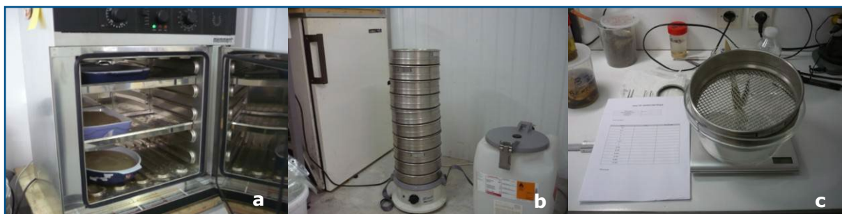
Figure 4 : Illustration des étapes de traitement en laboratoire : (a) séchage en étuve, (b) tamisage et (c) pesée (source : setec énergie environnement, 2022)
