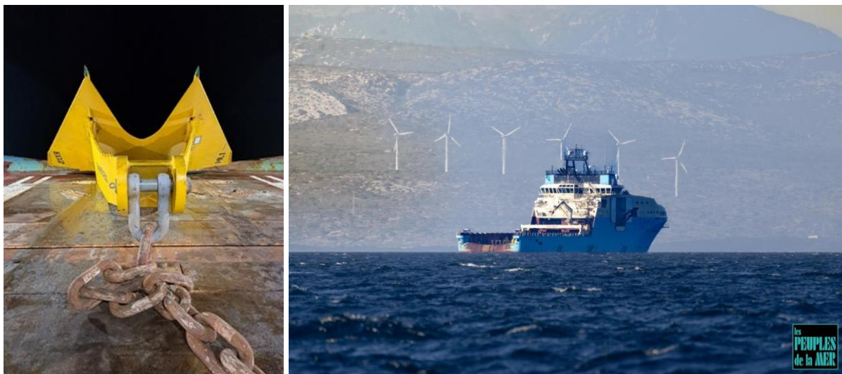
Figure 13 : (à gauche) Ancre DEA sur le pont du navire Maersk Mariner. (source : EFGL)
