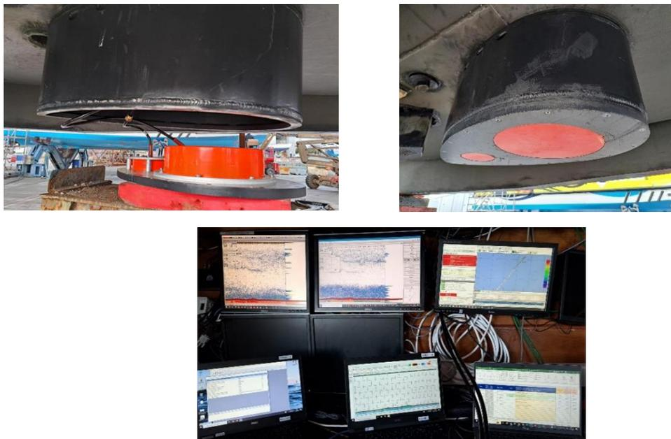
Figure 5 : Les 2 transducteurs de 38 et 120 kHz installés sous la coque du Minibex (en haut). Les outils utilisés à bord pour le paramétrage et le contrôle des transducteurs et la visualisation en temps réel des données acquises (en bas) (source : setec énergie environnement, 2025)
