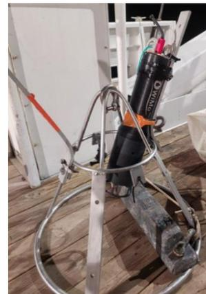
Figure 8 : Sonde WiMo Plus fixée à son bâti (source : setec énergie environnement, 2025)
