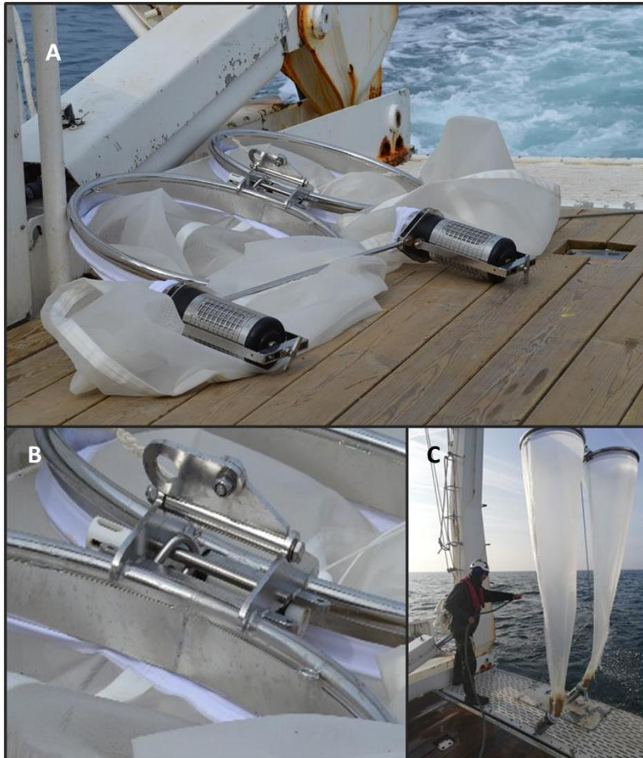
Photo 2 : Illustrations du double filet Bongo (source : setec énergie environnement, 2022)
