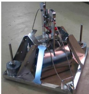
Photo 3 : Benne Day lestée (source : setec énergie environnement, 2022)
