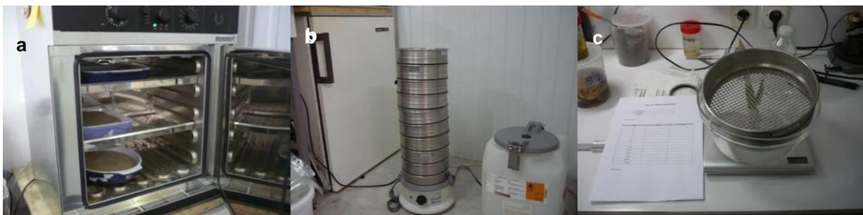
Photo 6 : Illustration des étapes de traitement en laboratoire : (a) séchage en étuve, (b) tamisage et (c) pesée (source : setec énergie environnement, 2022)
