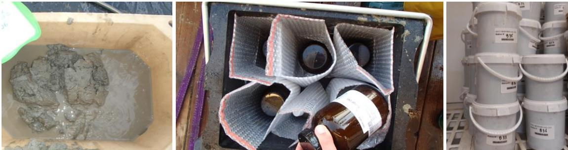
Photo 4 : Illustration du conditionnement des échantillons sédimentaires (source : setec énergie environnement, 2022)
