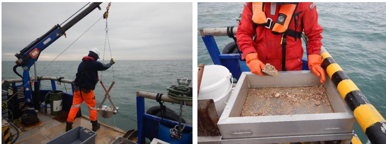
Figure 7. Aperçu des prélèvements à l'aide de la benne Van Veen, et du tamisage
