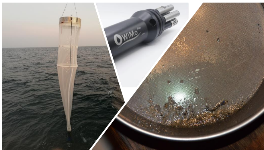
Figure 4. Filet WP2 ; sonde multi-paramètres Wimo mesurant T°C, S‰, O 2 et pH ; exemple d'un échantillon de plancton collecté au WP2 (source : NKE Instrumentation et setec énergie environnement)
