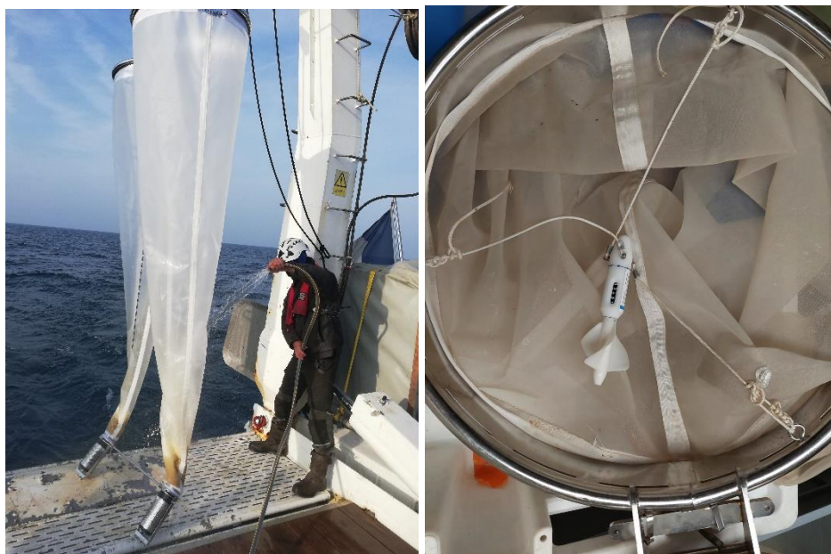
Figure 22. Vue de profil du filet bongo à gauche, débitmètre fixé à l'entrée du filet à droite
