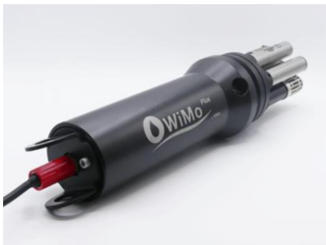
Figure 10 : Sonde WIMO Plus (source : NKE).
