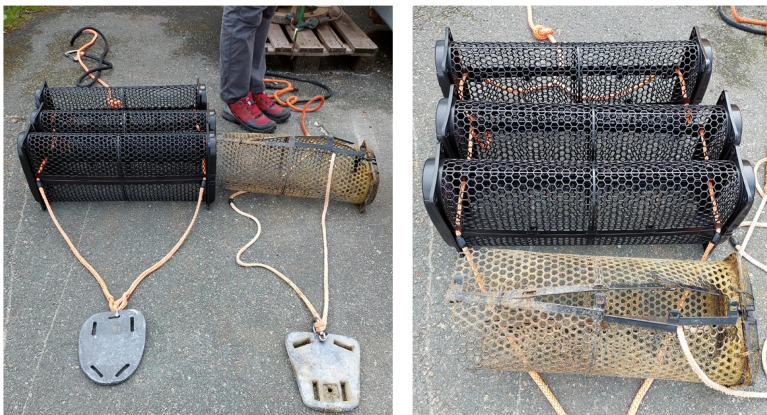
Figure 6 : Photos des cages confectionnées avant mise à l'eau (de couleur noire et en bon état) et de la seule cage récupérée sur PMT01 (endommagé et vide).
