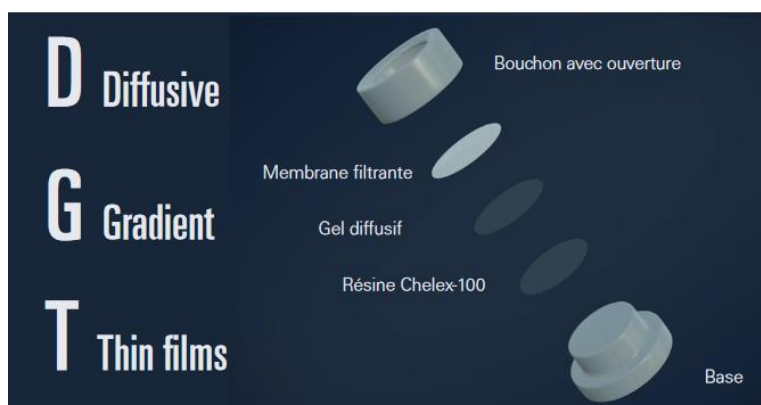
Figure 12 : Composition d'un DGT pour les composants métalliques (source : Projet MONITOOL).
