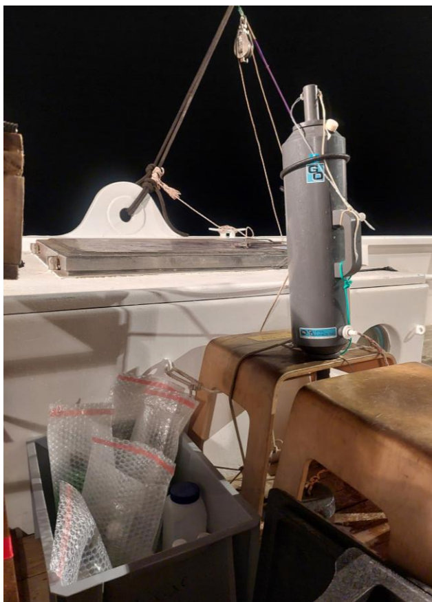
Figure 9 : Poste de travail pour la qualité de l'eau lors de la campagne de mars 2023 : poulie de mise à l'eau, bouteille Niskin sur son support et flacons Eurofins.
