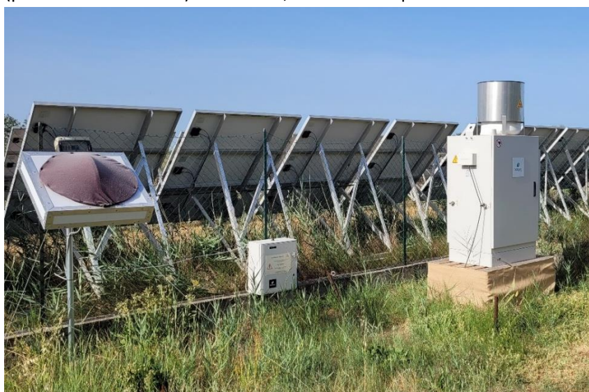
Figure 2 : Dispositif acoustique oiseaux avec la parabole (à gauche) et le coffret contenant l'enregistreur (au centre)
