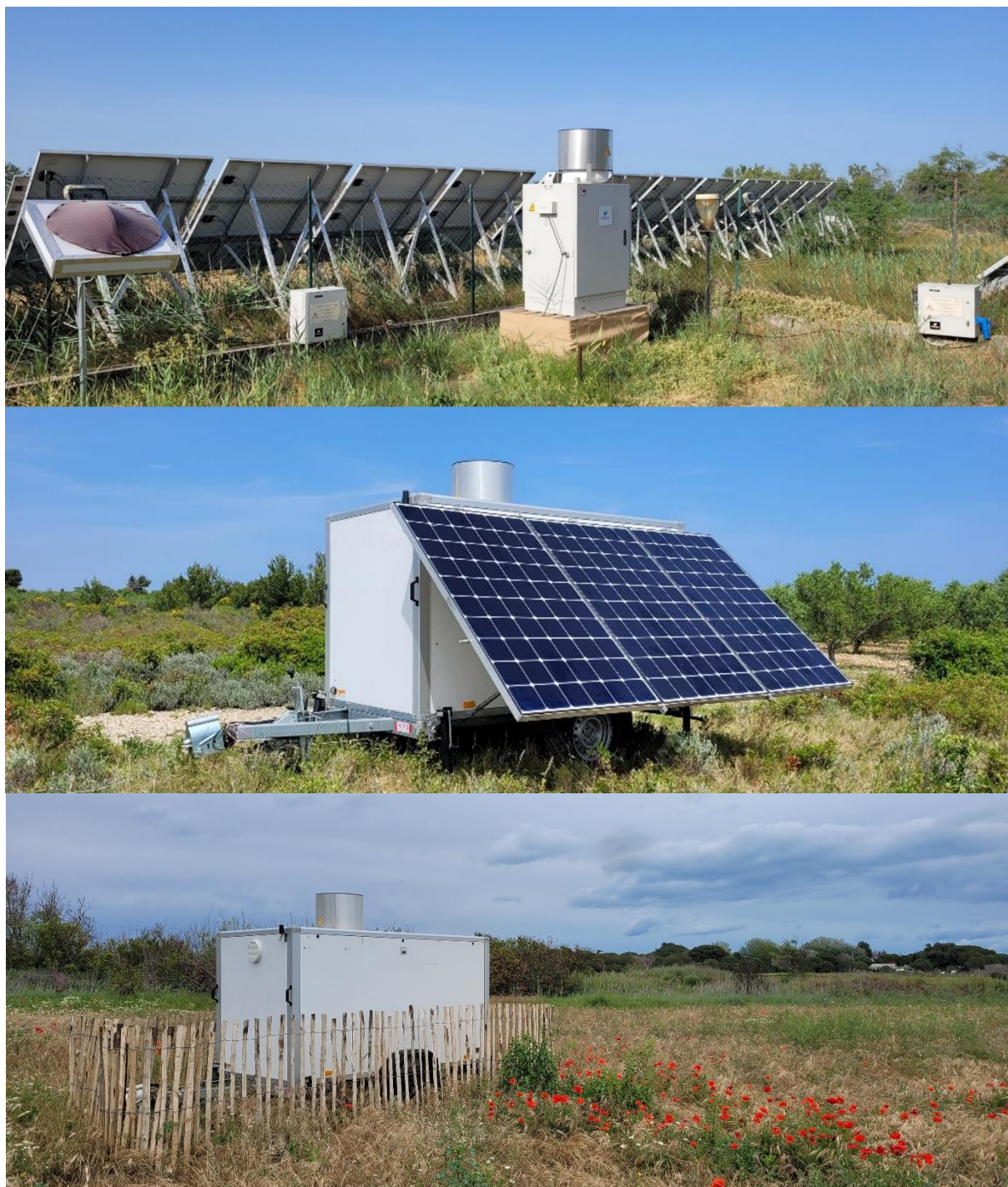
Figure 3 : Dispositifs déployés pour les suivis par radars ornithologiques à la côte. En haut, le radar fixe installé au domaine de la Palissade (Camargue), au milieu, l'unité radar mobile dans sa configuration autonome pour les années 2022 et 2023, et en bas la remorque modifiée pour acquérir les données en continu sur le site du Bagnas (Agde).
