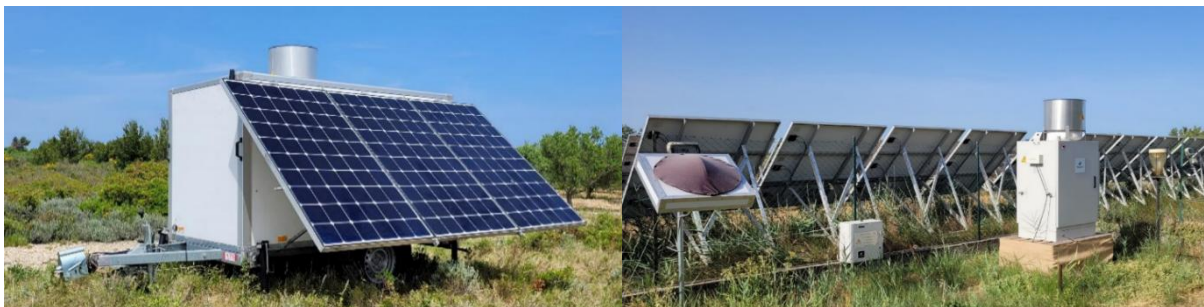
Dispositifs déployés pour les suivis par radars ornithologiques à la côte. A gauche, l'unité radar mobile et à droite le radar fixe installé au domaine de la Palissade (Camargue).
