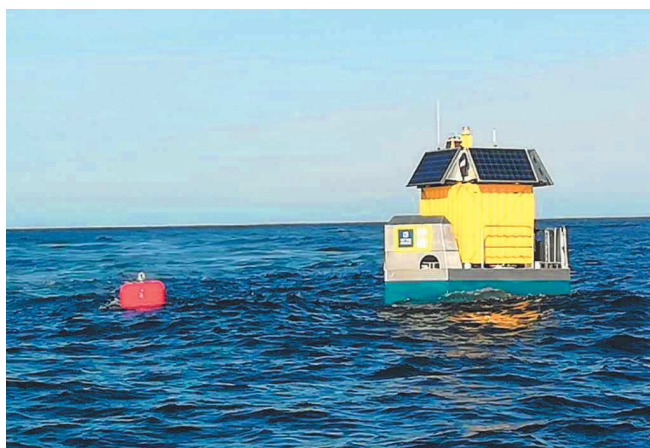
Illustration 2 : Photo d'une bouée exploitée par Akrocéan . Cette bouée embarque notamment un LiDAR, une station météorologique et des capteurs océanographiques.
