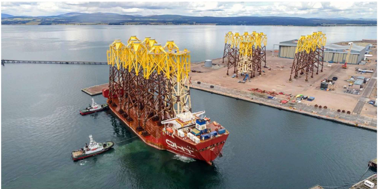
Figure 5-4 Transport des structures jacket pour le parc éolien offshore de Moray East
