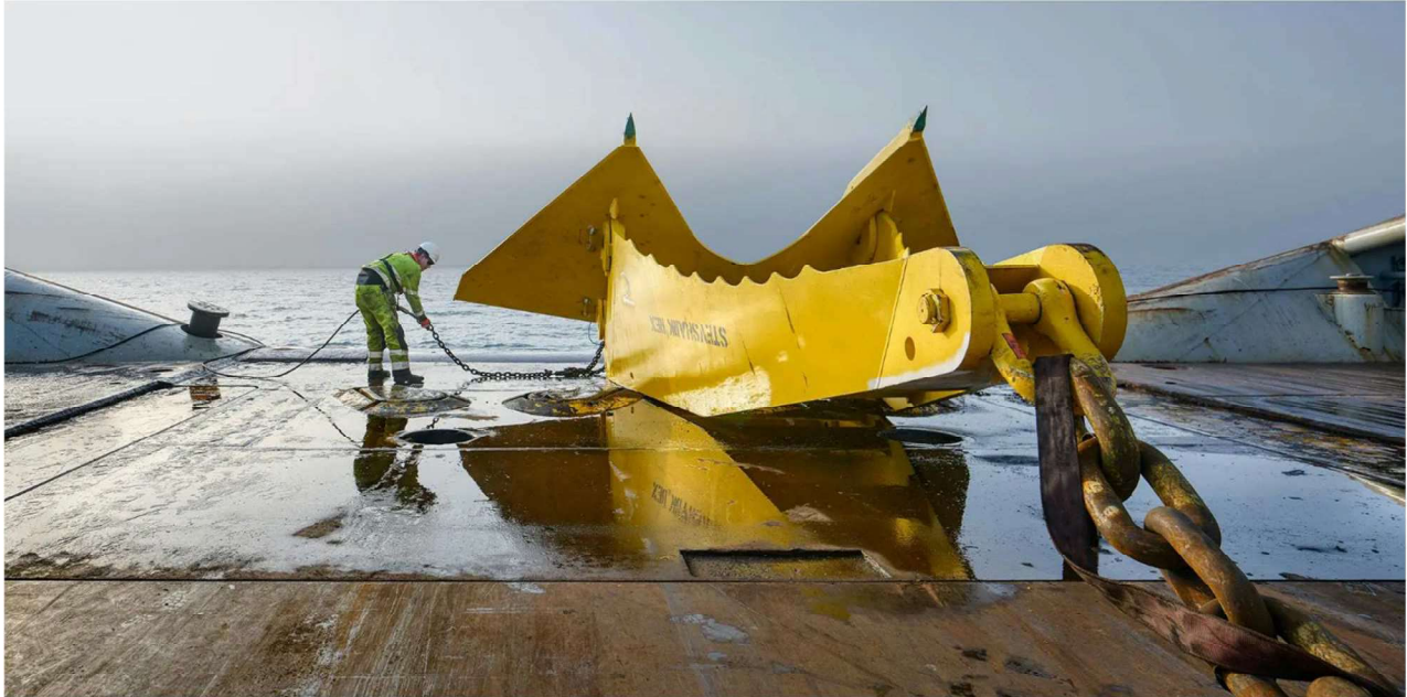
Figure 5-7 Ancre à enfouissement par traction à bord d'un navire AHV Source : Principle Power, https://www.principlepower.com/windfloat/advantage/installation , consulté le 13 octobre 2025
