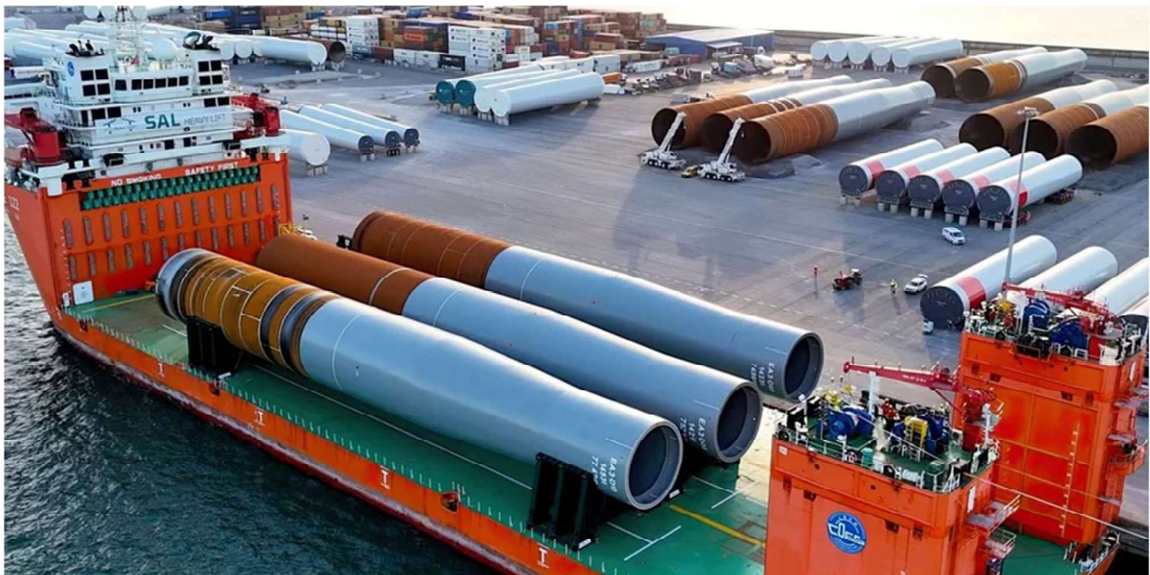
Figure 4-3 Navire de transport avec East Anglia Three fondations monopieux (profondeur d'eau 25 à 49 m)
