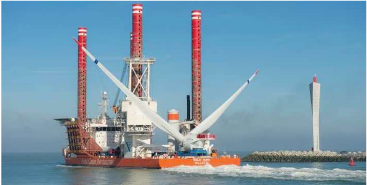
Figure 5-10 Transport d'une turbine « Bunny ear » pour le parc éolien offshore de Belwind
