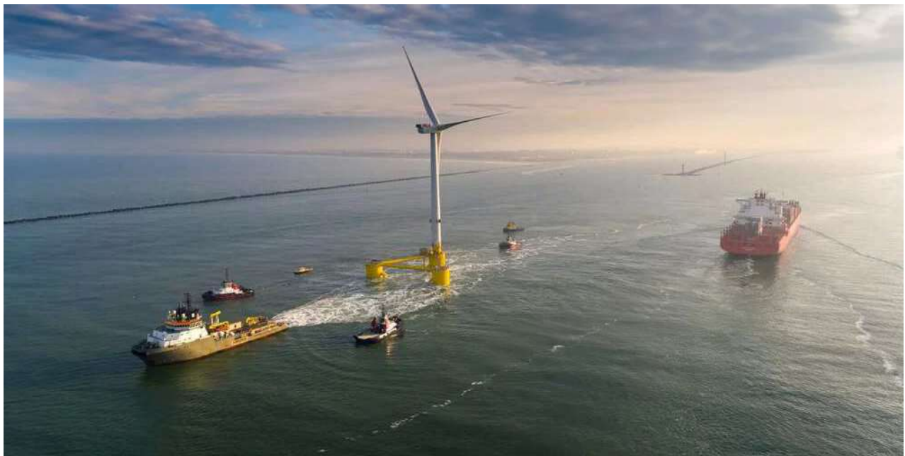
Figure 4-6 Remorquage d'un flotteur vers le parc éolien offshore de Kincardine
