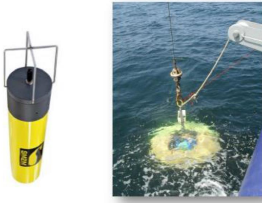
Figure 8 : Gauche : SM2M de la société Wildlife Acoustics. Droite : mise en œuvre de la cage instrumentée (source : Quiet-Oceans)
