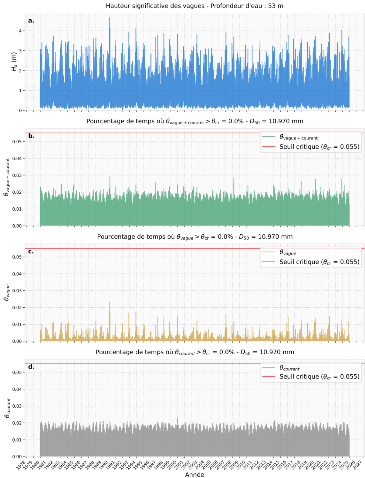
Figure 34. Séries temporelles de 1980 à 2024 pour D_{50} = 10.970 mm au Point P1 (Ouest). a. Hauteur significative des vagues ( H_s ), b. Paramètre de Shields total ( \theta_{vague + courant} ), c. Paramètre de Shields associé aux vagues ( \theta_{vague} ), d. Paramètre de Shields associé au courant ( \theta_{courant} ).
