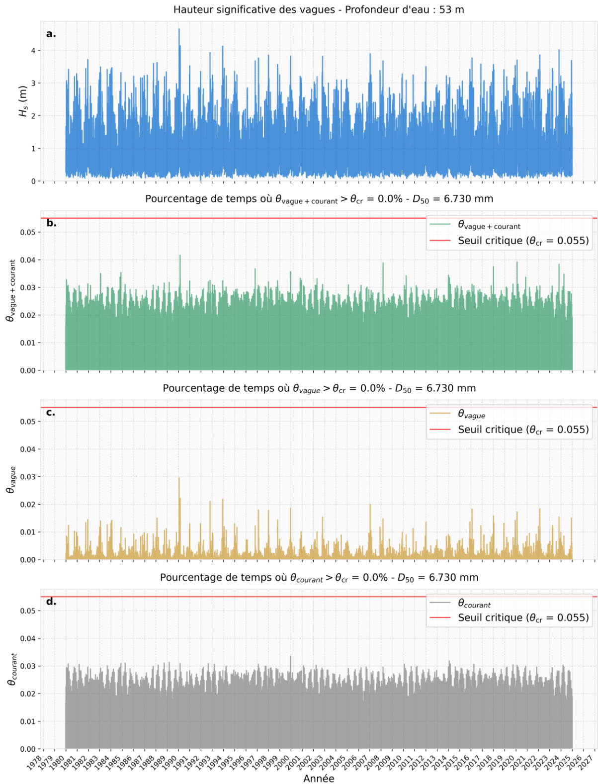
Figure 33. Séries temporelles de 1980 à 2024 pour D_{50} = 6.730 \text{ mm} au Point P1 (Ouest). a. Hauteur significative des vagues ( H_s ), b. Paramètre de Shields total ( \theta_{\text{vague} + \text{courant}} ), c. Paramètre de Shields associé aux vagues ( \theta_{\text{vague}} ), d. Paramètre de Shields associé au courant ( \theta_{\text{courant}} ).
