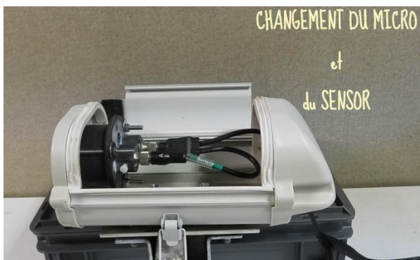
Photo. 1 : boîtier étanche d'O-GEO pour microphone et sensor du Batlogger WEX1 avec capot permettant l'accès aux équipements
