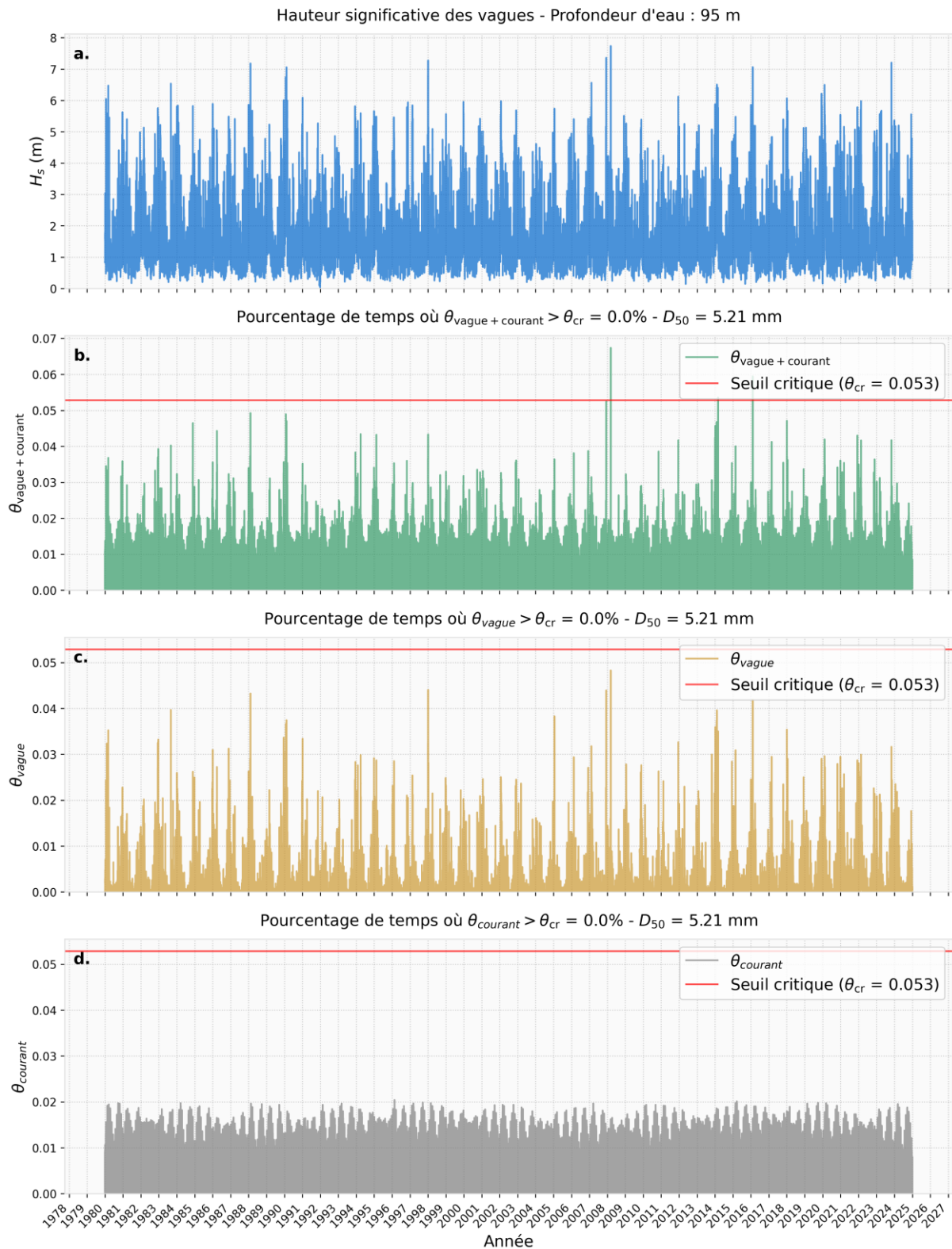
Figure 81. Séries temporelles de 1980 à 2024 pour D_{50} = 5.21 mm au Point P3. a. Hauteur significative des vagues ( H_s ), b. Paramètre de Shields total ( \theta_{\text{vague} + \text{courant}} ), c. Paramètre de Shields associé aux vagues ( \theta_{\text{vague}} ), d. Paramètre de Shields associé au courant ( \theta_{\text{courant}} ).
