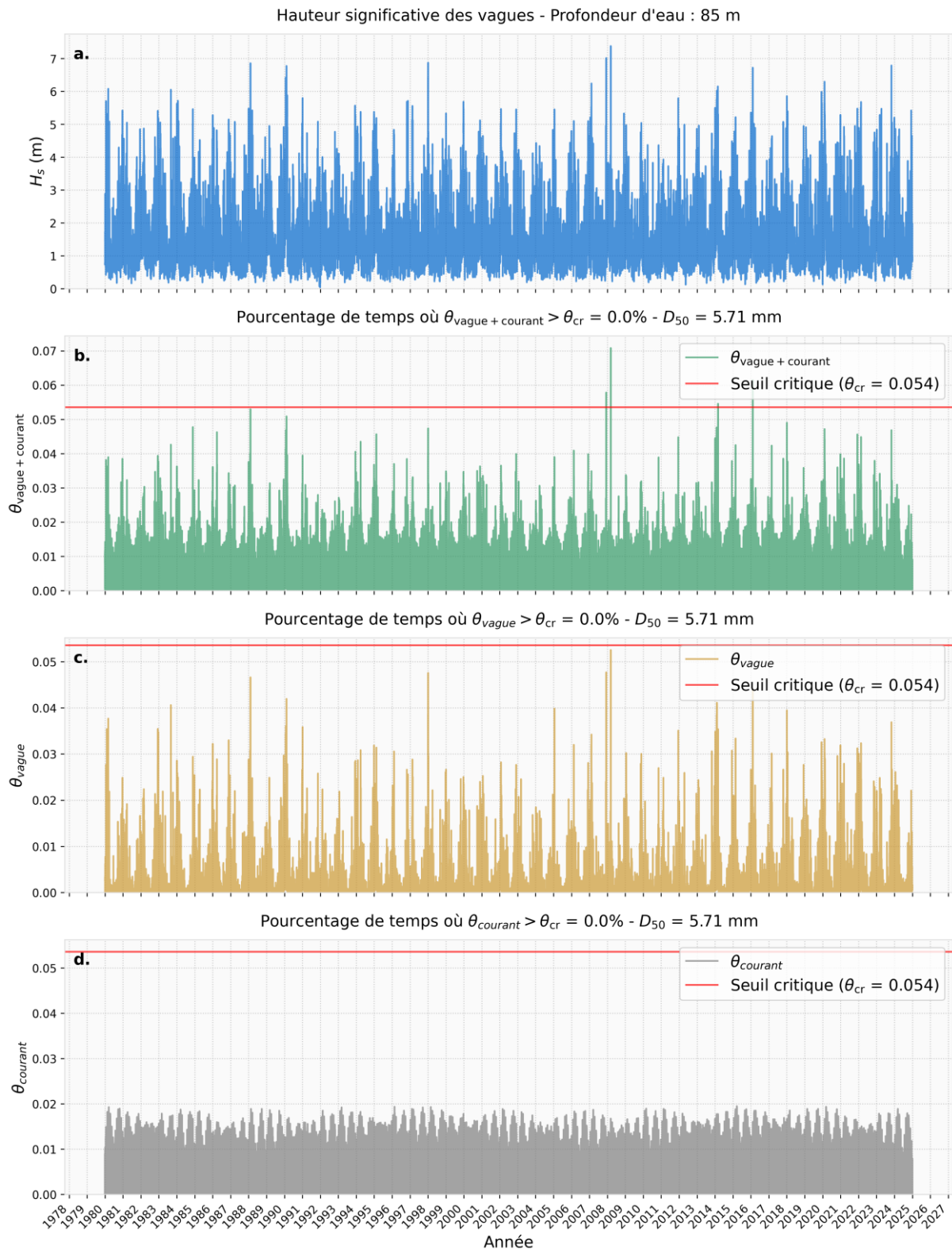
Figure 38. Séries temporelles de 1980 à 2024 pour D_{50} = 5.71 mm au Point P1. a. Hauteur significative des vagues ( H_s ), b. Paramètre de Shields total ( \theta_{\text{vague} + \text{courant}} ), c. Paramètre de Shields associé aux vagues ( \theta_{\text{vague}} ), d. Paramètre de Shields associé au courant ( \theta_{\text{courant}} ).
