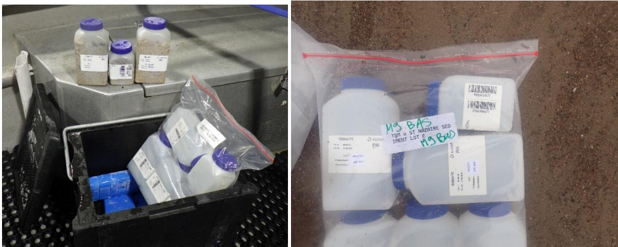
Figure 13 : Exemple de flaconnage fourni par le laboratoire EUROFINS pour l'analyse des contaminants dans les sédiments.
