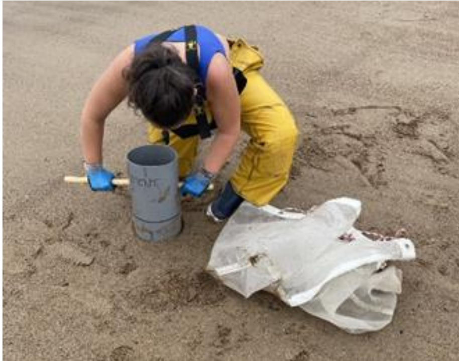
Figure 4: Carottier à main et tamis pour les peuplements benthiques de substrats meubles
