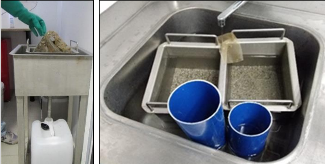
Figure 14. Etapes du déformolage : récupération de l'eau formolée (à gauche) et rinçage (à droite) (©TBM environnement).
