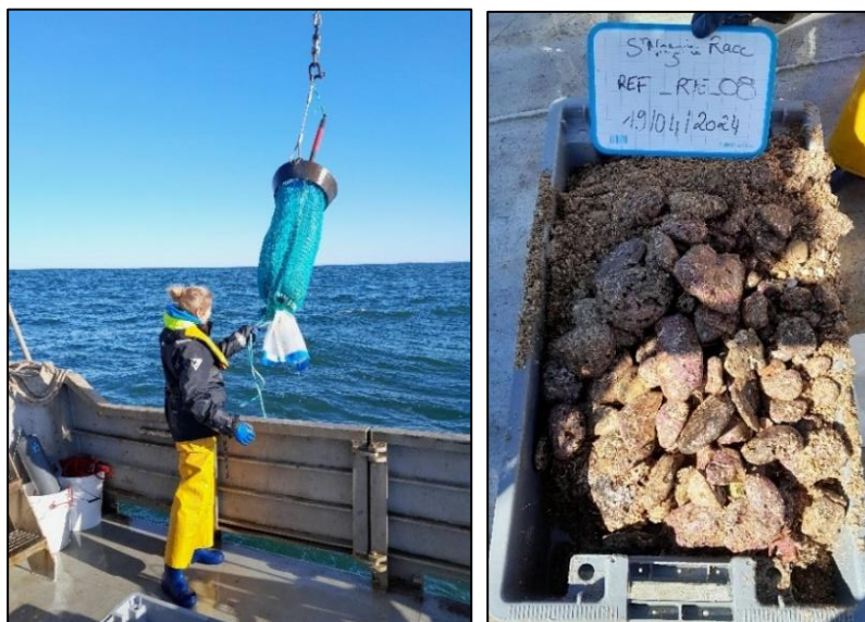
Figure 12 : À gauche, remontée de la drague rallier du Baty et à droite, exemple de prélèvement réalisé (© TBM environnement)
