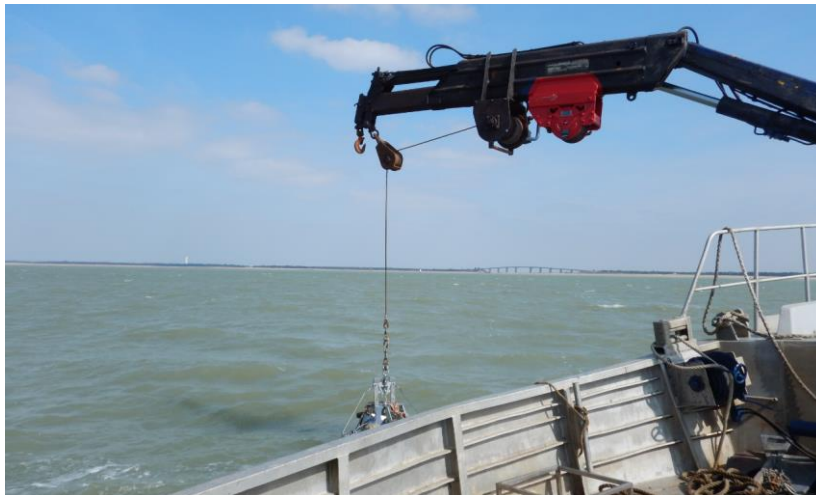
Figure 18. Echantillonnage à l'aide de la benne Day depuis le navire TZIGANE
