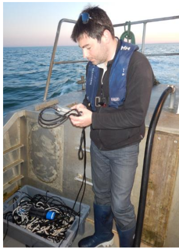
Figure 21. Paramétrage du boîtier d'enregistrement de la sonde, et immersion
