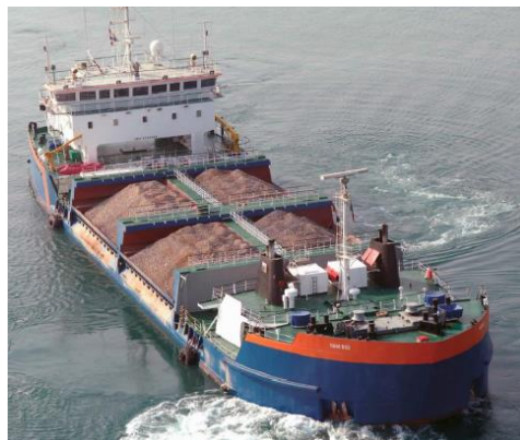
Figure 66. Enrochement par tuyau d'amené (à gauche : fall pipe ) ou par navire de transbordement (à droite : side dumping ) (Source : RTE, 2016)
