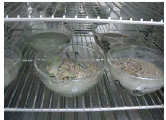
Figure 9 : Echantillons granulométriques à l'étuve (Cliché TBM).
