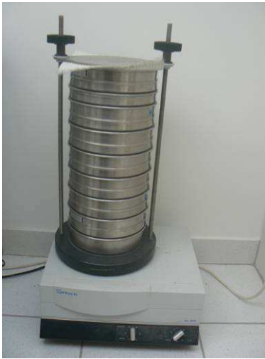
Figure 8 : Colonne de tamis (Cliché TBM).
