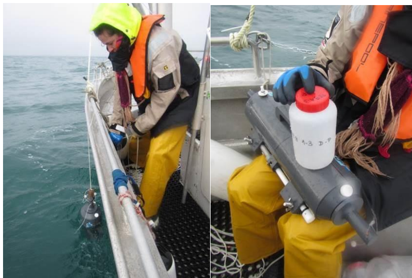
Figure 10 : Mise en œuvre d'une bouteille Niskin (TBM environnement)
