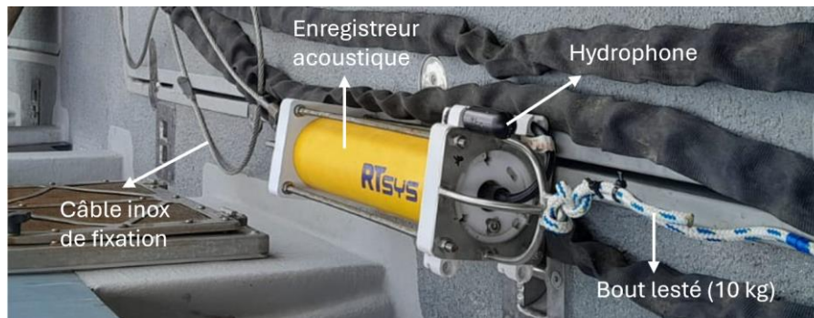
Figure 8. Système d'acquisition acoustique large bande (enregistreur et hydrophone) déporté de la ligne de mouillage et prêt à être déployé (Source : SOMME).
