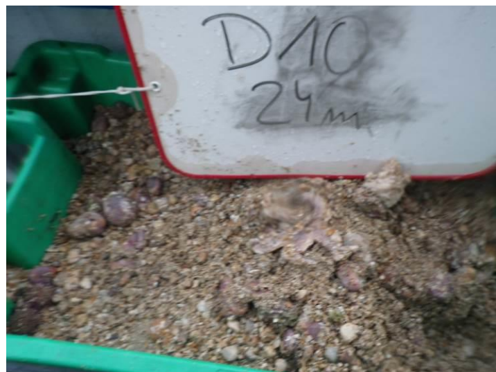
Figure 12 : Illustrations des différents types sédimentaires observés à la drague rallier du Baty : sédiments très fins (D01), sédiments fins à moyens (station D23), sédiments moyens et grossiers (stations D24 et D19), sédiments graveleux et cailloutis (station D10).
