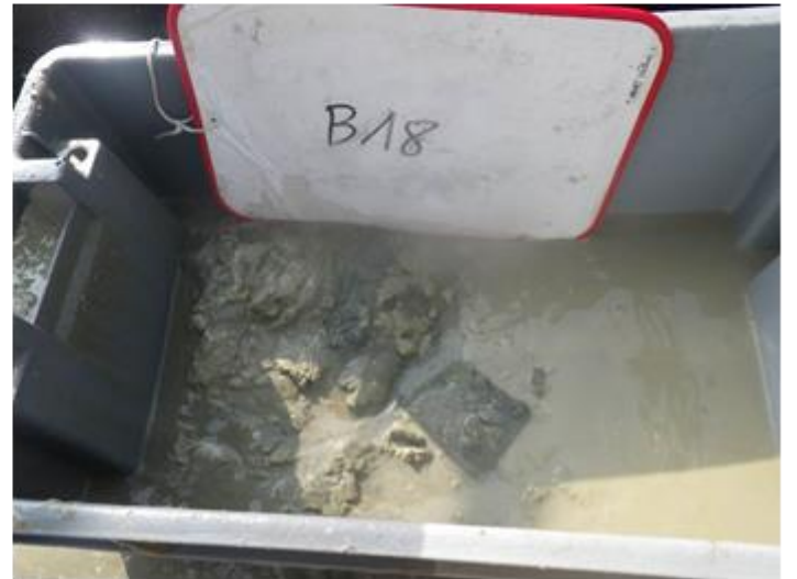
Figure 14 : Illustrations des différents types sédimentaires observés à la benne Day : sédiments graveleux (station B08), sédiments grossiers (station B15), sédiments fins à moyens (station B09), et sédiments fins légèrement envasés (station B18).
