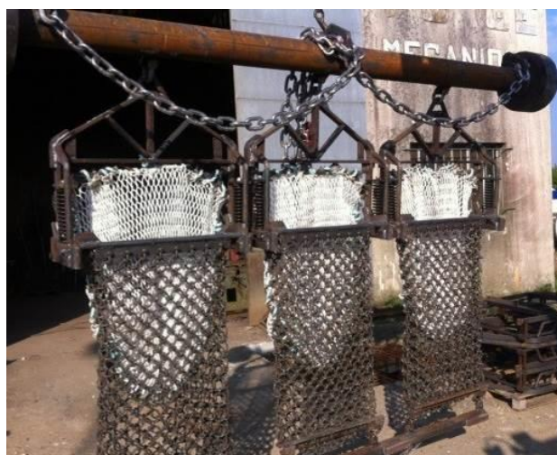
Figure 7 : Drague à coquilles (Source : TBM environnement)
