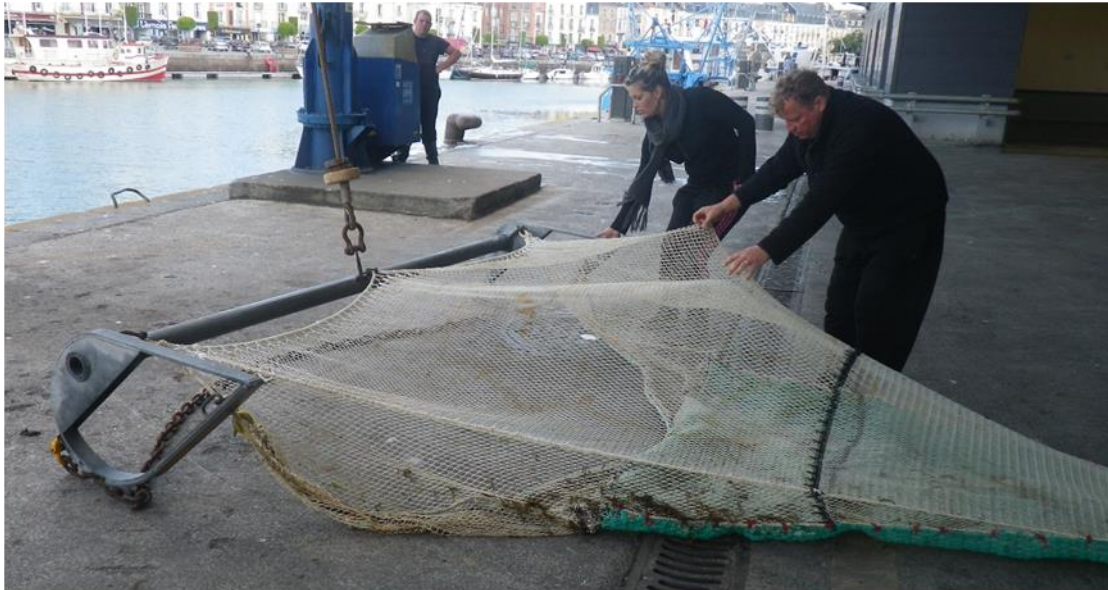
Figure 5 : Chalut à perche (Source : TBM environnement)
