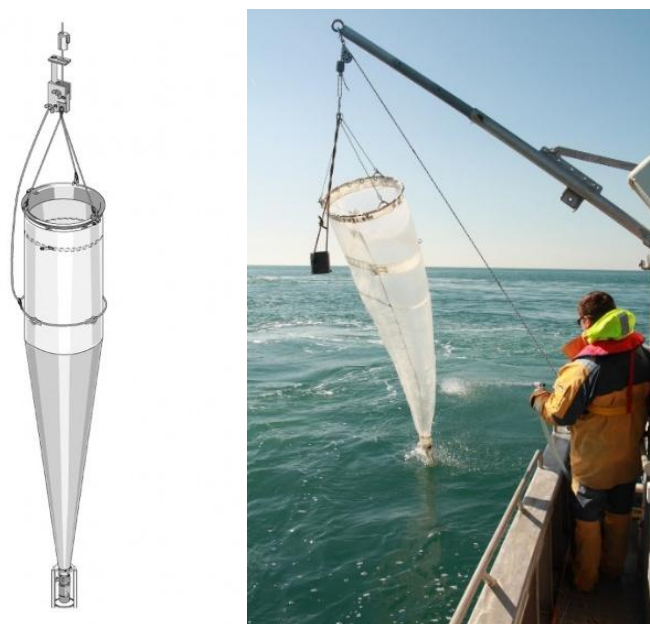
Figure 5 : filet WP2 servant au prélèvement du zooplancton équipé d'un dépresseur et d'un volucompteur mécanique (Bionef® / Ifremer®).
