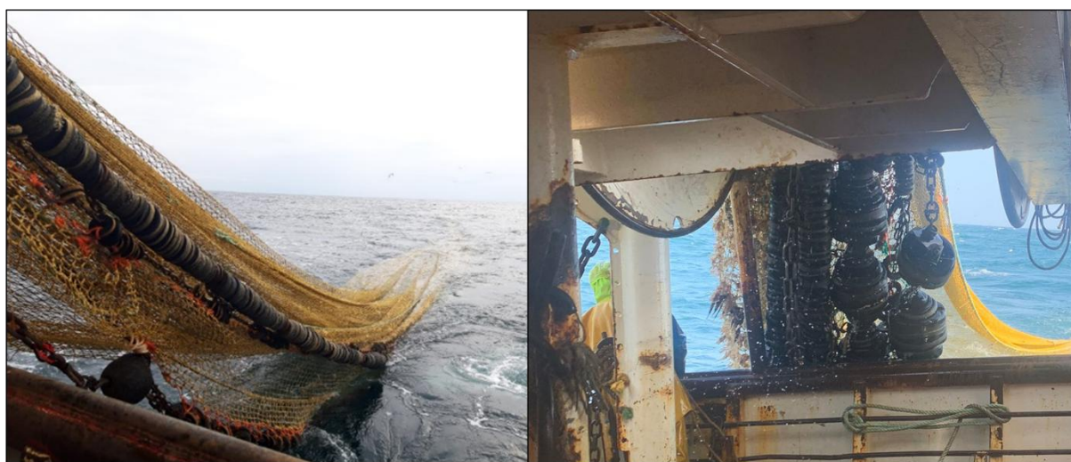
Figure 7 : chalut canadien utilisé pour l'étude des espèces benthodémersales.
