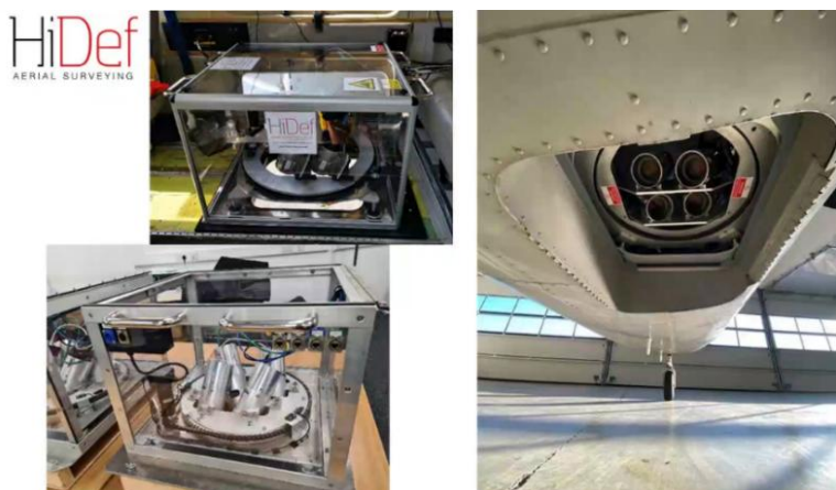
Figure 4 : système caméras HiDef GEN 2.5 dans son coffre de protection et câbles de connexion vers le serveur (à gauche) et aperçu de ce système sous un avion (à droite) (Source : HiDef aerial surveying).
