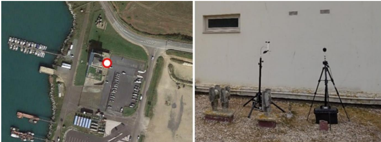
Figure 1 : exemple de sonomètre et station météorologique déployés pour l'étude du bruit ambiant aérien dans le cadre du parc éolien Centre-Manche. Déploiement en toiture terrasse de la capitainerie du port d'Antifer – Saint-Jouin Bruneval (76).
