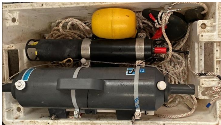
Figure 3 : dispositif comprenant une bouteille de prélèvement de type Niskin téflonnée d'une contenance de cinq litres et une sonde WiMo multi-paramètres.
