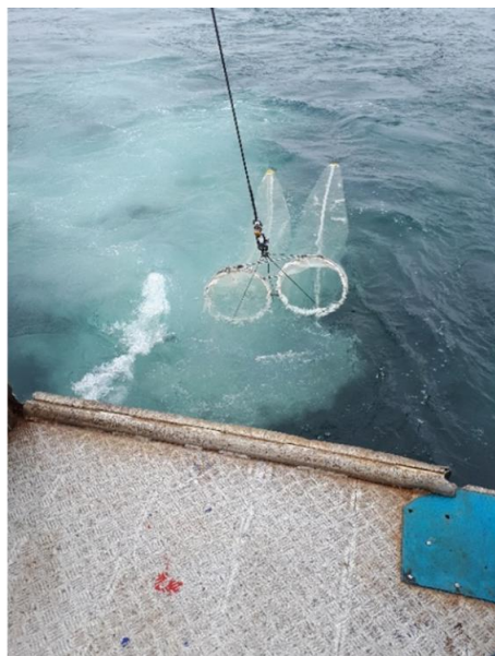
Figure 6 : filet Bongo à double collecteur servant au prélèvement de l'ichtyoplancton équipé d'un dépresseur et d'un volucompteur mécanique (Bionef®).
