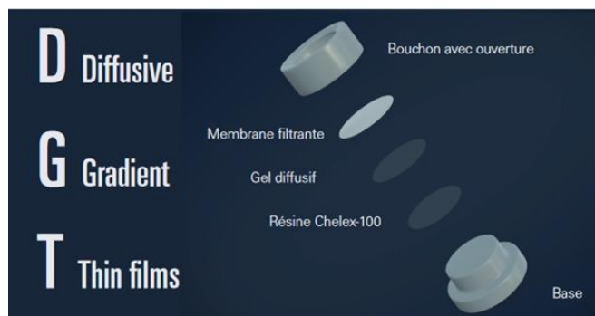
Figure 6 : structure d'un DGT (Source : Projet MONITOOL).
