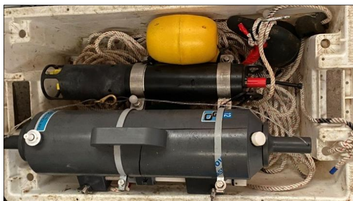
Figure 5 : dispositif comprenant une bouteille de prélèvement de type Niskin d'une contenance de cinq litres et une sonde multi-paramètres WiMo.
