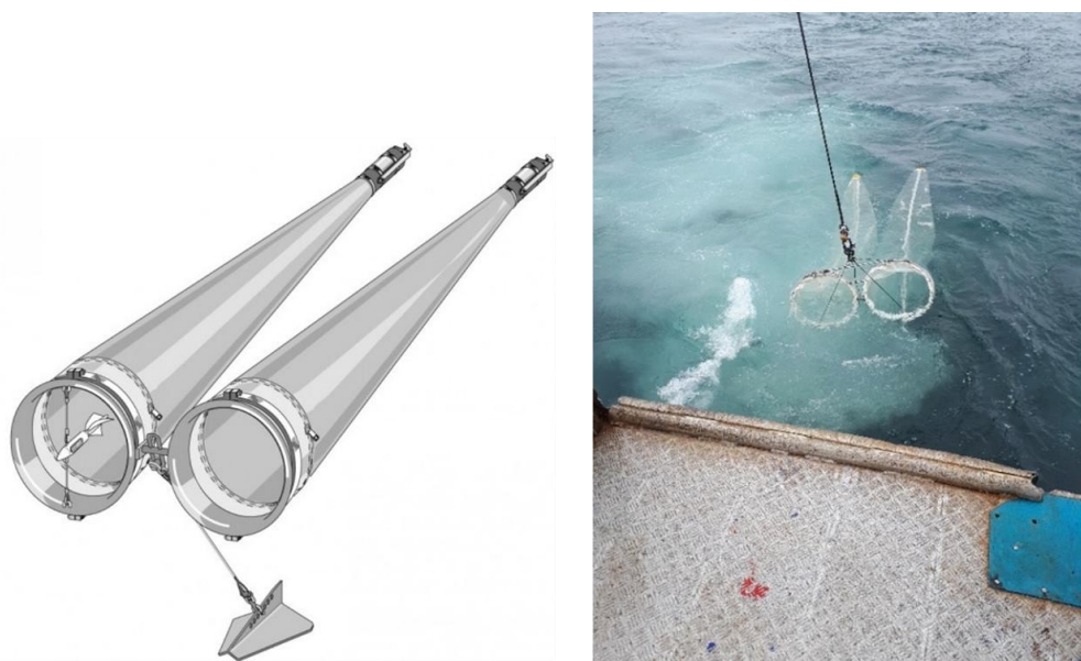
Figure 4 : filet Bongo à double collecteur servant au prélèvement de l'ichtyoplancton équipé d'un dépresseur et d'un volucompteur mécanique (Bionef®).
