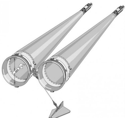
Figure 6 : filet Bongo à double collecteur servant au prélèvement de l'ichtyoplancton équipé d'un dépresseur et d'un volucompteur mécanique (Bionef®).
