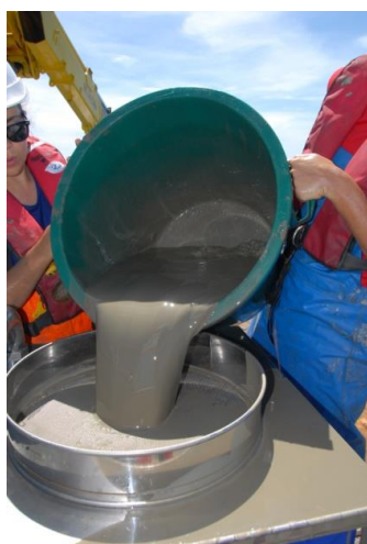
Figure 4. Tamisage du sédiment
