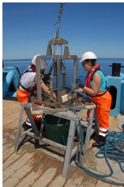
Figure 2. Mise à l'eau de la benne (sur la gauche) et récupération du prélèvement (sur la droite)
