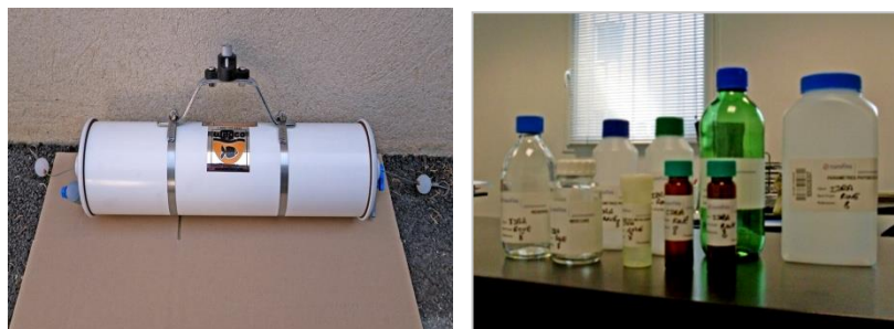
Figure 4 - Bouteille Niskin et flacons spécifiques avec stabilisant (matériel : Wildco)
