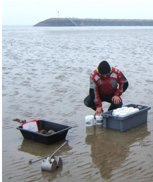
Figure 8. Manipulation de la benne Van Veen utilisée sur l'estran (0,025m 2 ) à la station SP1-EST (Erquy)
