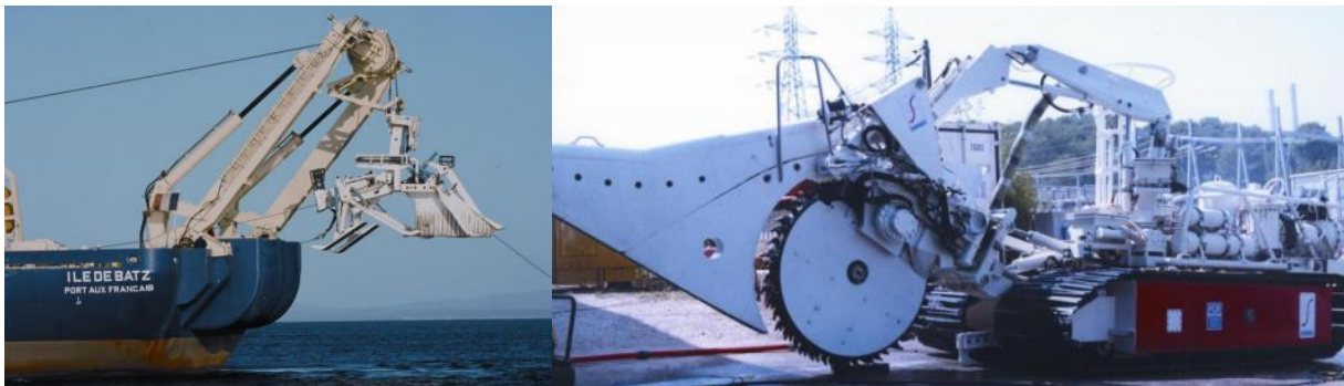
Figure 101. Aperçu des engins pouvant être immergés pour la pose d'un câble sous-marin (Bigot, 2010)
