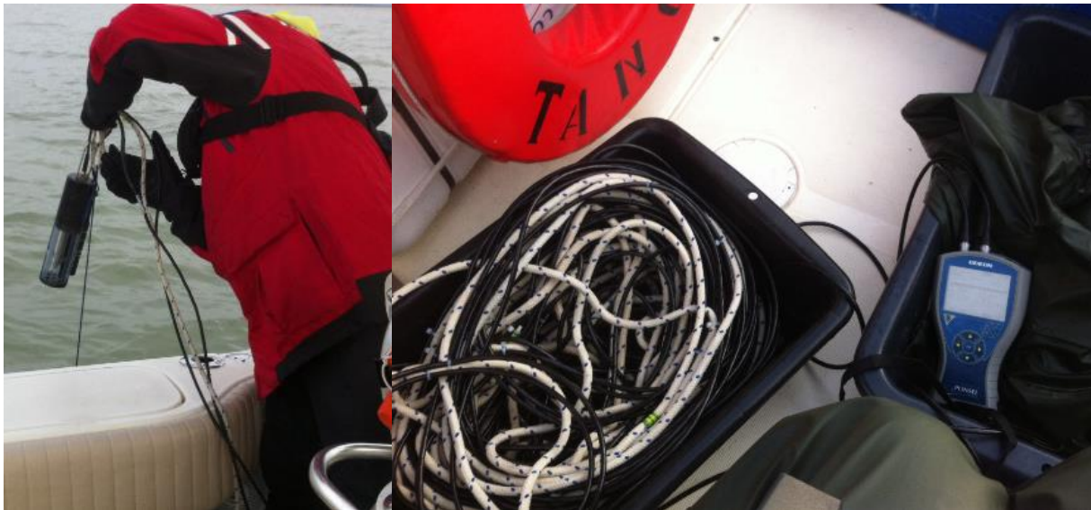
Figure 5 ; Mise à l'eau de la sonde ODEON, et système d'enregistrement associé
