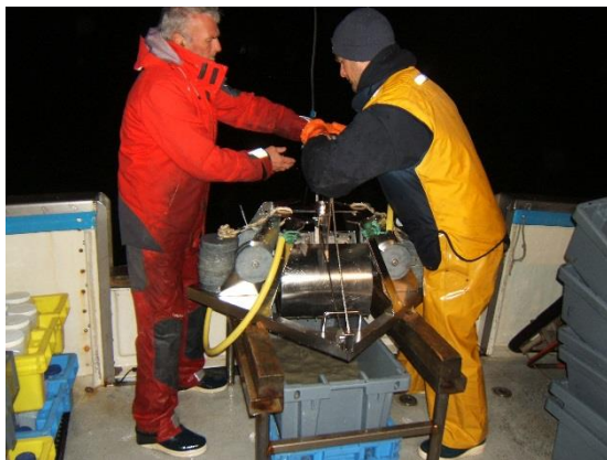
Figure 7. Aperçu de la manipulation de la Day grab, et des 4 réplicats d'une station
