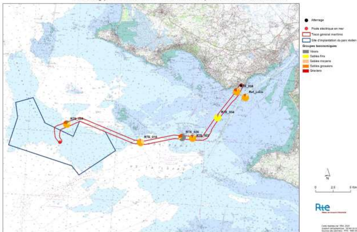
Figure 12 : Cartographie des fractions granulométriques pour les 7 stations du suivi de la qualité des sédiments
