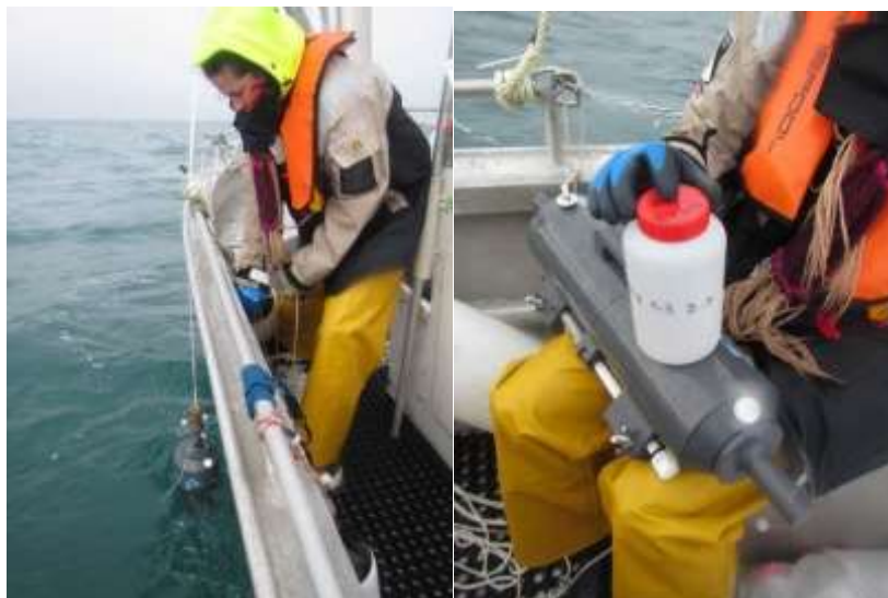
Figure 3 : Mise en œuvre d'une bouteille Niskin (TBM environnement)
