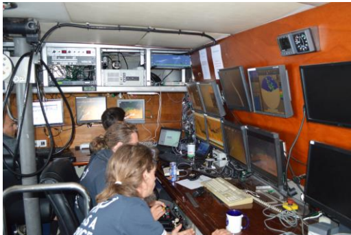
Photo 5: Poste de pilotage du ROV et d'acquisition vidéo à bord du Minibex (source : SAAS)
