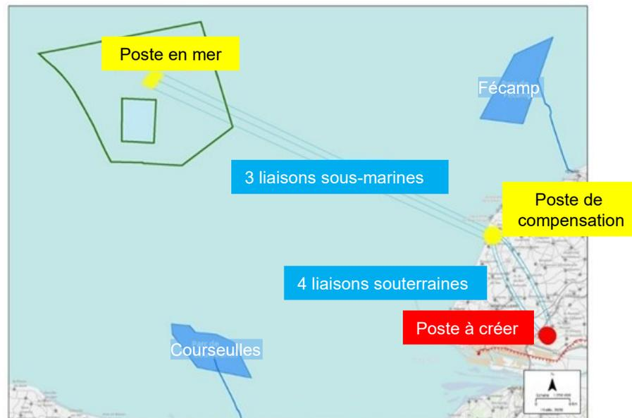
**Schéma de principe d'un raccordement vers la zone du Havre**
